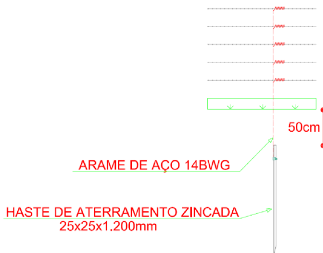
Figura 17 – Detalhe do Aterramento
