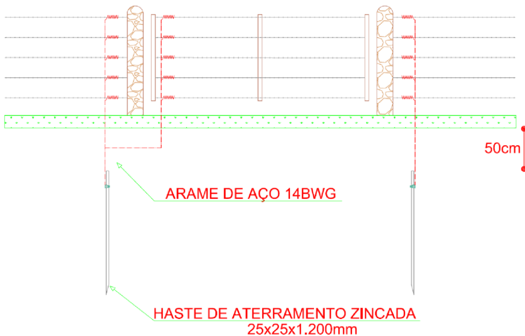
Figura 19 – Aterramento em Porteira
